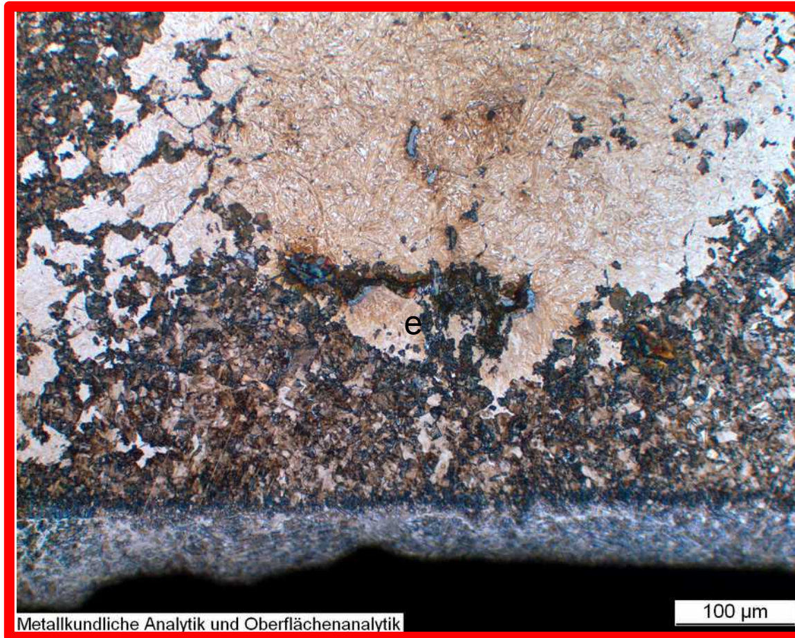
Härteriss in einer brenngeschnittenen Schiene
